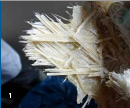
1 Multiaxiales Glasfasergelege aus einem Kompositbauteil. 2 Rotorblatt beim Rückbau einer Windkraftanlage.
